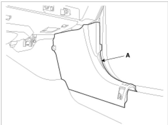
6. 使用螺丝刀或拆卸工具拆卸仪表板下盖[右] (A)。
