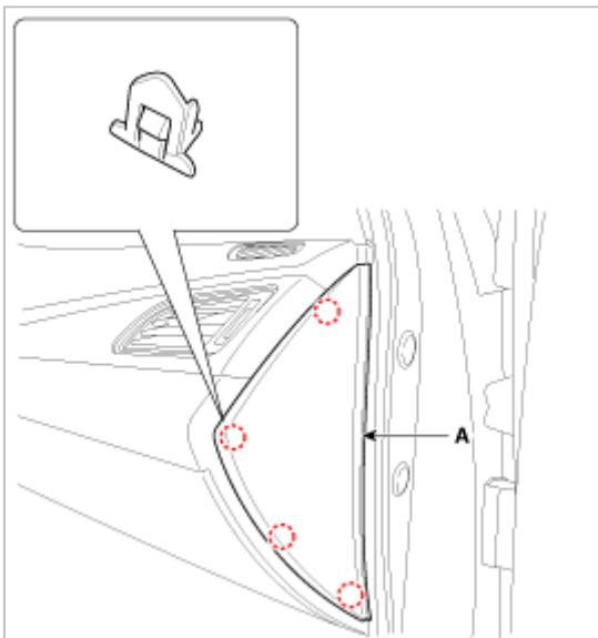
9. 拧下固定螺钉后，拆卸助手席侧仪表板装饰板(A)。
