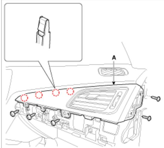
11. 使用螺丝刀拧下固定螺钉，拆卸手套箱上盖总成(A)。
