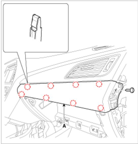
10. 拧下固定螺钉，拆卸仪表板侧面装饰板总成[右] (A)。
