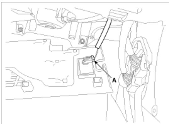
8. 使用螺丝刀或拆卸工具拆卸仪表板侧盖[右](A)。
