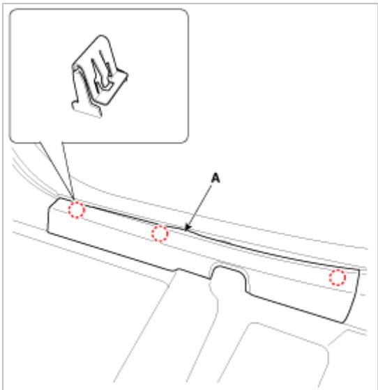
5. 使用螺丝刀或拆卸工具拆卸车颈侧装饰板[右] (A)。
